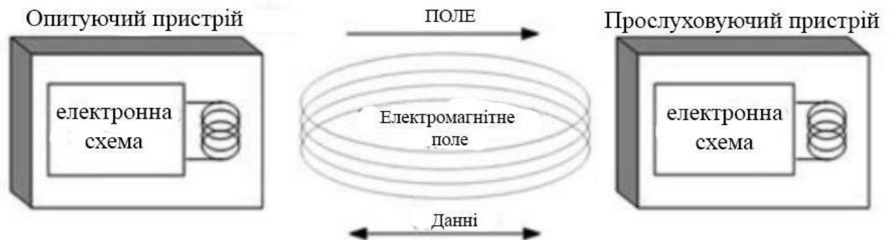
Рисунок 1.8 —Принцип роботи технології NFC
