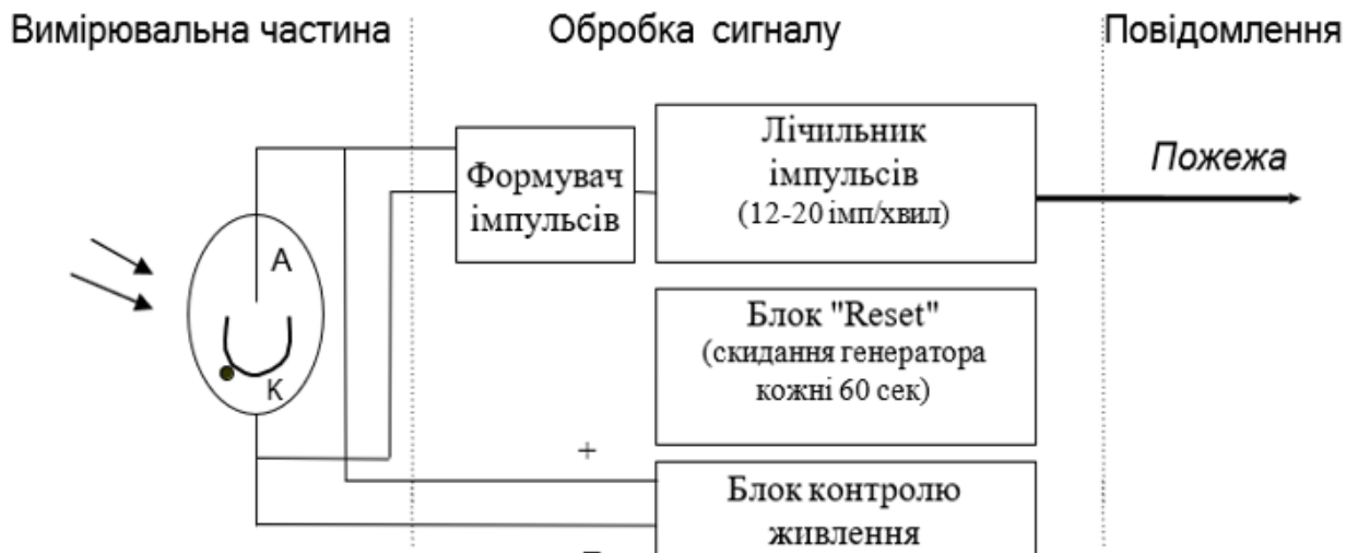
Рисунок 1.12 — Структурна схема ультрафіолетового оповіслювача
