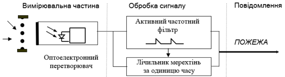
Рисунок 1.13 — Структурна схема інфрачервоного сповіщувача полум'я
