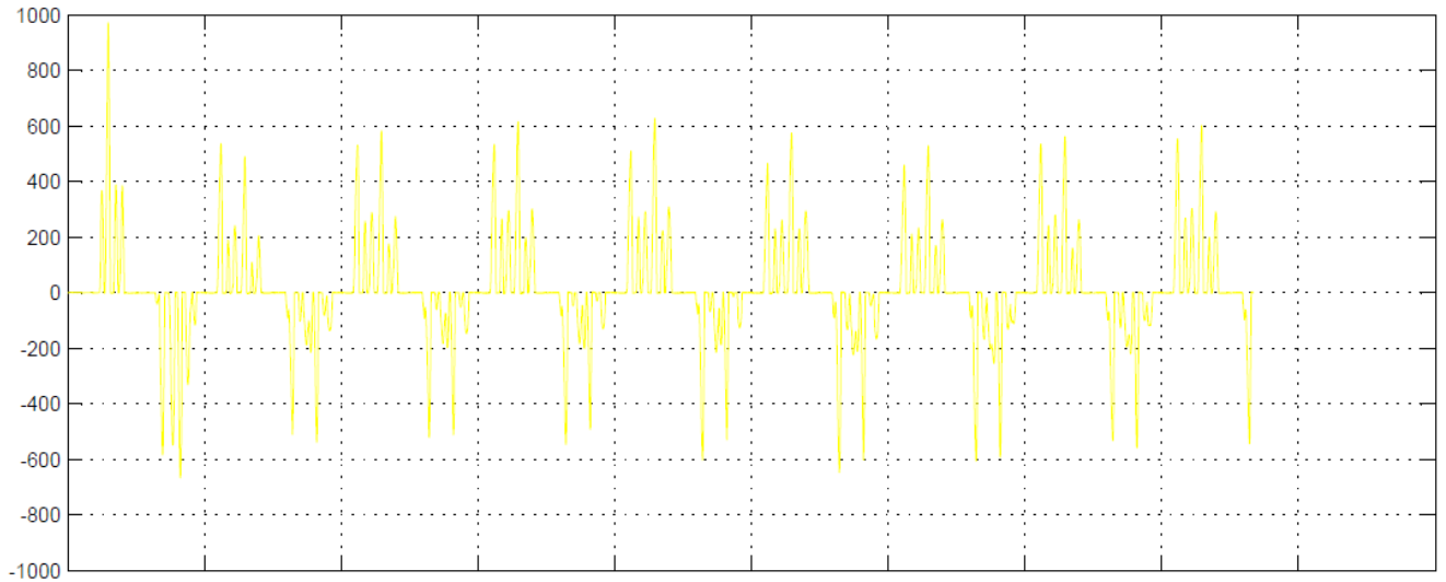
Рисунок 3.2 – Струм фази А на вході перетворювача частоти
