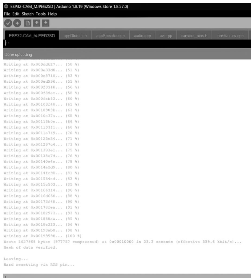
Рисунок 3.2 — Вікно середовища Arduino IDE під час прошивки мікроконтролера
