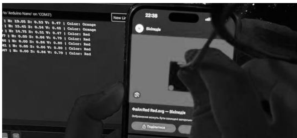
Рисунок 2.14 — Реакція датчика та логіки на червоний колір
