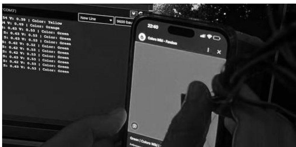
Рисунок 2.15 - Реакція датчика та логіки на зелений колір
