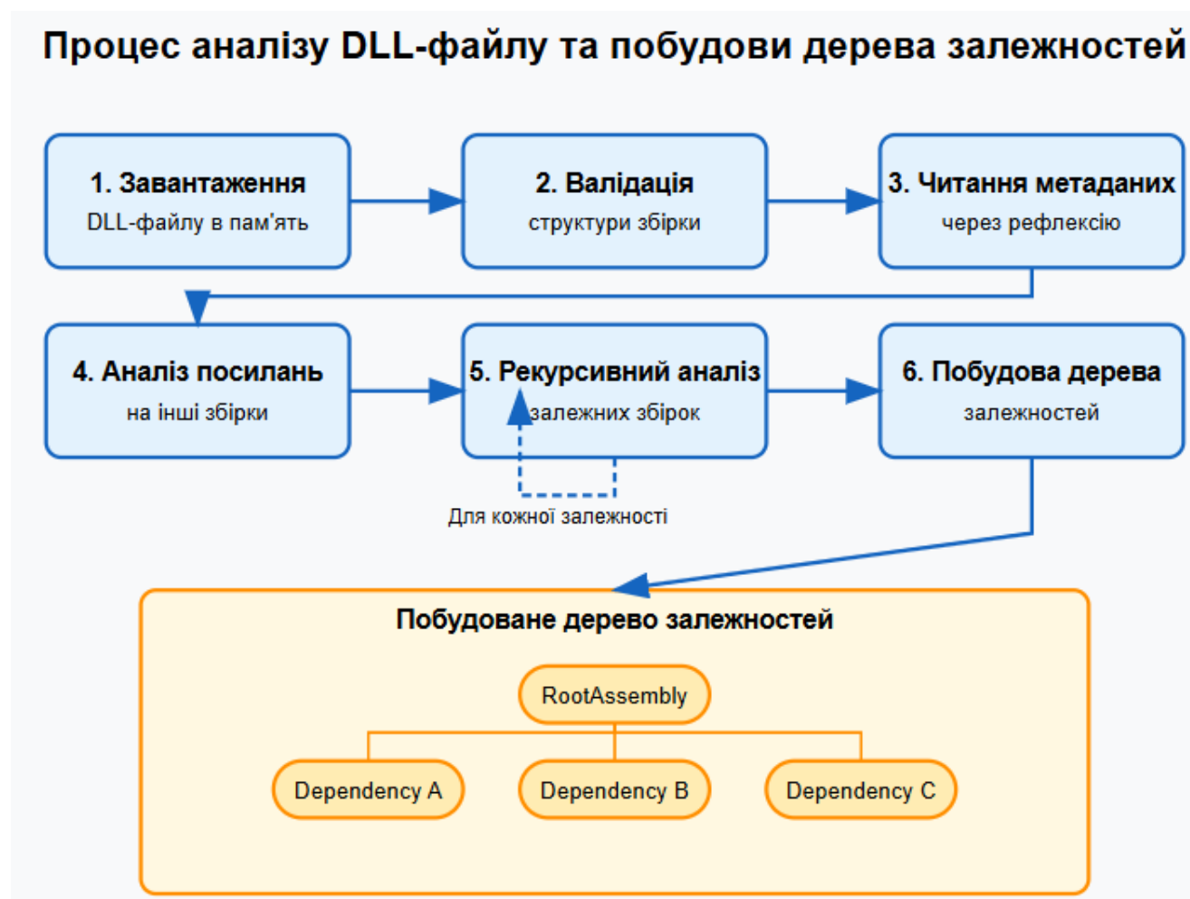
Рисунок 2.5 — Процес аналізу DLL-файлу із побудовою дерева залежностей
