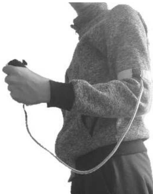
Рисунок 4.3 — Спосіб кріплення датчика гіроскопа на операторі
