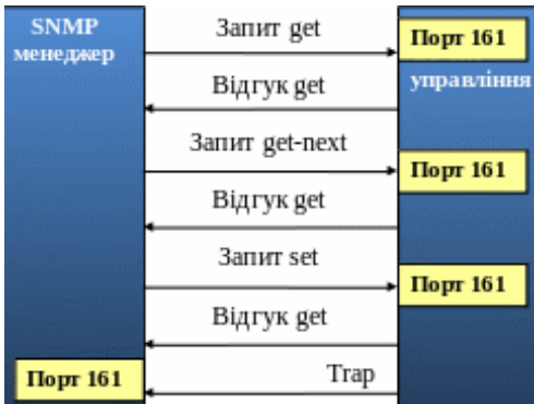
Рисунок 2.17— Схема роботи SNMP протоколу
