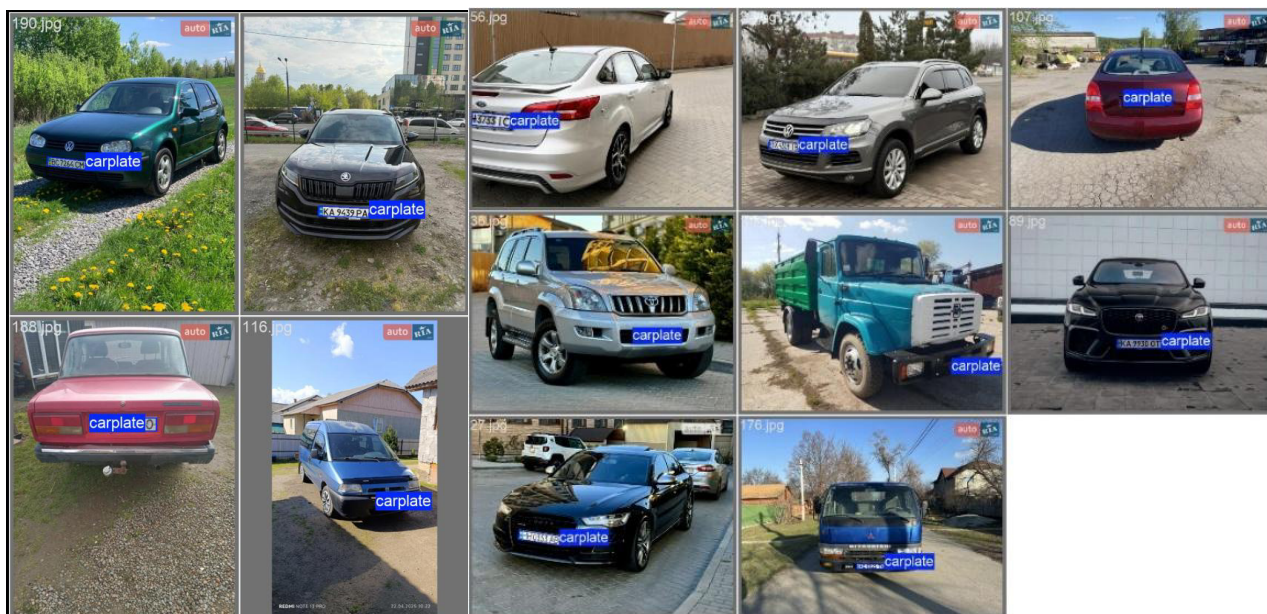
Рисунок 3.9 — Тестування детекції номерних знаків на новому наборі даних
