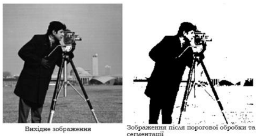
Рисунок 2.1 — Приклад застосування методу порогового сегментування
