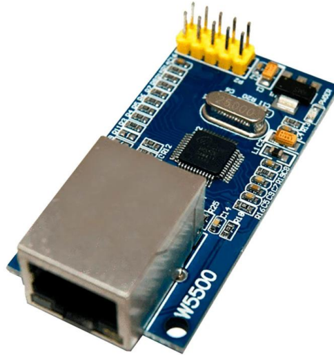
Рисунок 2.5 — Модуль WIZnet W5500
