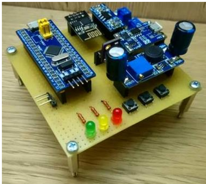
Рисунок 1.7 — Моніторингова станція ентузіаста на базі STM32
