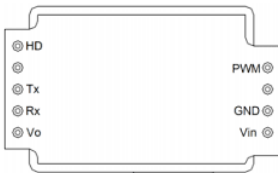
Рисунок 3.5 — Піни та їхнє призначення сенсора CO 2 MH-Z19B
