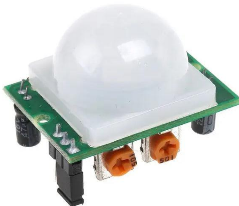
Рисунок 3.2 — Інфрачервоний датчик руху PIR
