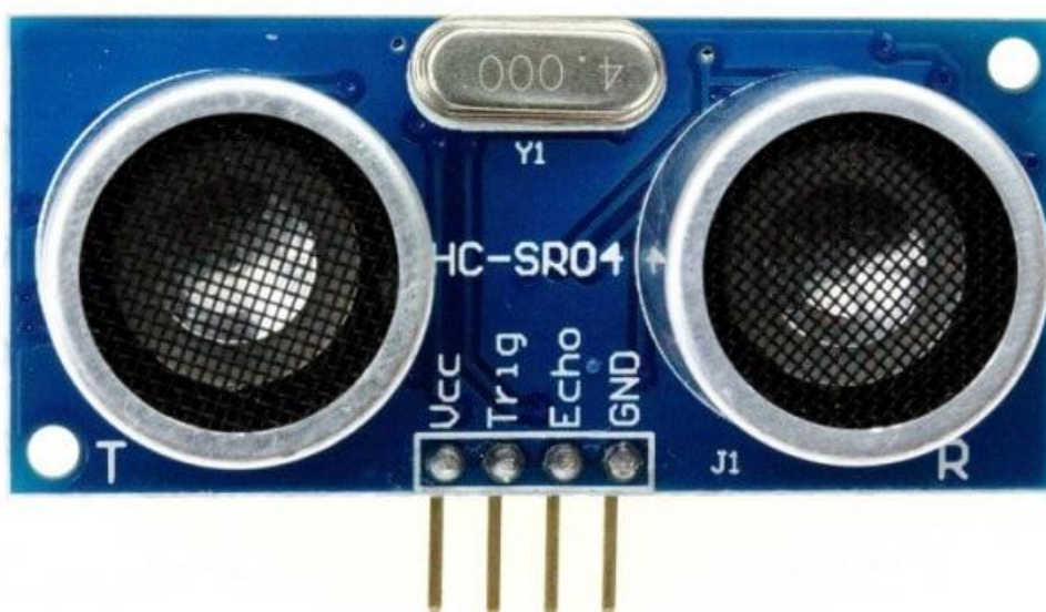
Рисунок 3.3 — Ультразвуковий далекомір HC-SR04
