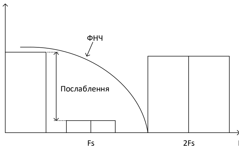
Рисунок 2.3 — Схема роботи інтерполюючого фільтра
