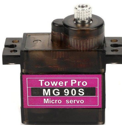
Рисунок 3.7 – Зображення серводвигунів для керування пальцями
