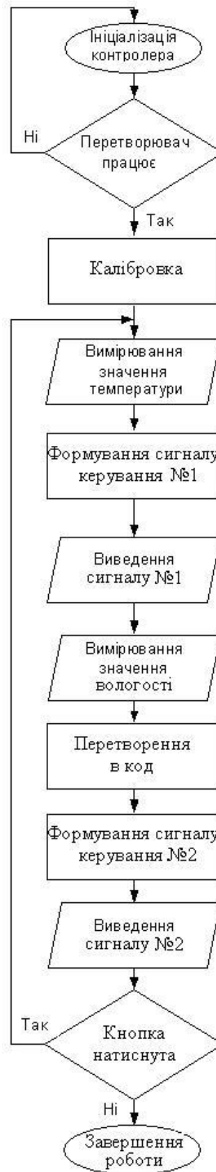
Рисунок 4.1 – Блок-схема алгоритму роботи пристрою
