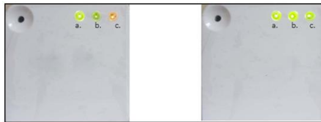
Рисунок 2.16 – IP-шлюз, не підключений до інтернету ( ліворуч )/та підключений до інтернету ( праворуч )
