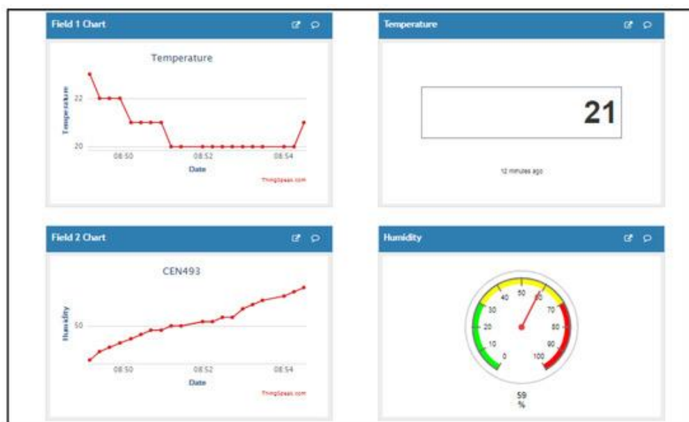
Рисунок 2.26 – Результати вимірювання температури та вологості з сенсора DHT на сервері
