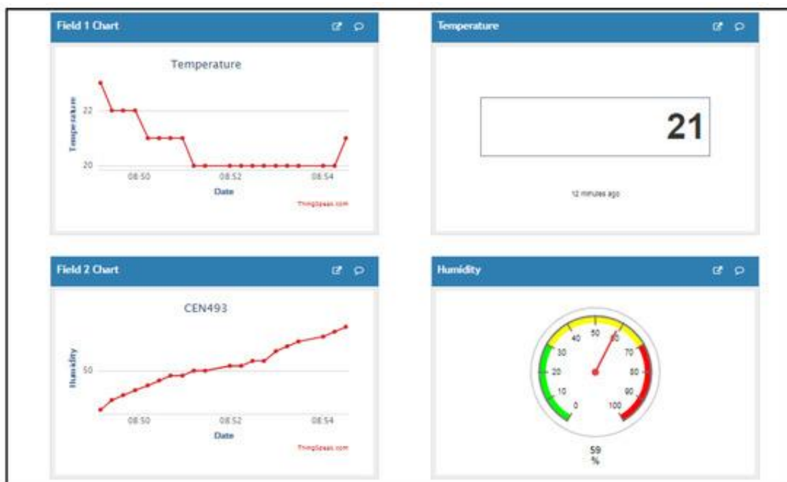
Рисунок 12 – Результати вимірювання температури та вологості з сенсора DHT на сервері
