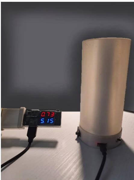
Рисунок 15 – Дослідження споживання електроенергії, а) при вимкненому пристрої, б) при увімкненому
