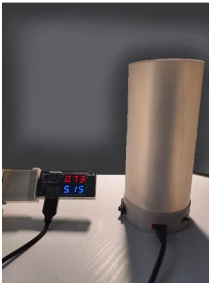
Рисунок 3.17 – Дослідження споживання електроенергії: а) – при вимкненому пристрої, б) – при увімкненому пристрої
