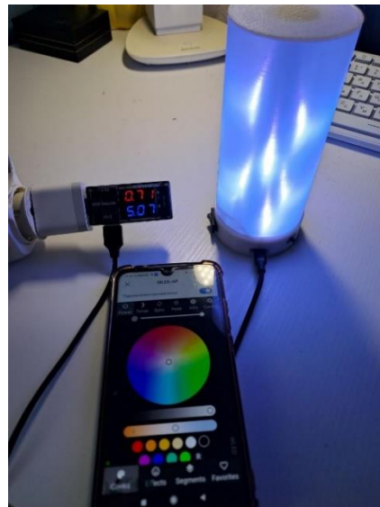
Рисунок 3.17 – Дослідження споживання електроенергії: а) – при вимкненому пристрої, б) – при увімкненому пристрої
