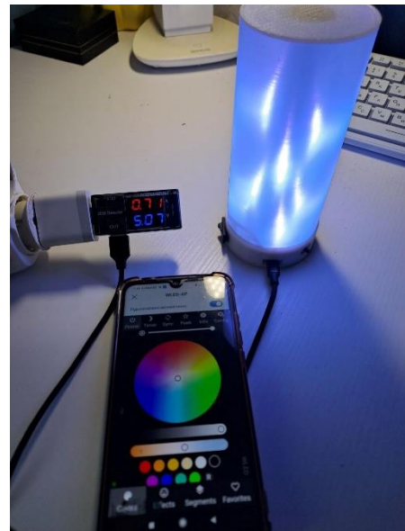
Рисунок 15 – Дослідження споживання електроенергії, а) при вимкненому пристрої, б) при увімкненому
