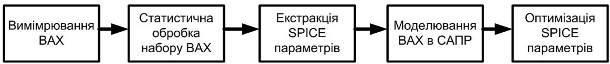
Рисунок 6 – Блок схема етапів моделювання HSCH-9161
