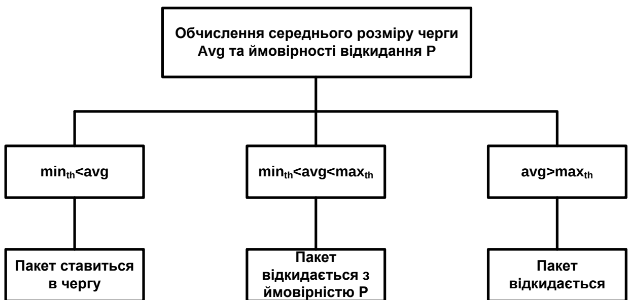
Рисунок 2 – Схема роботи алгоритму RED
