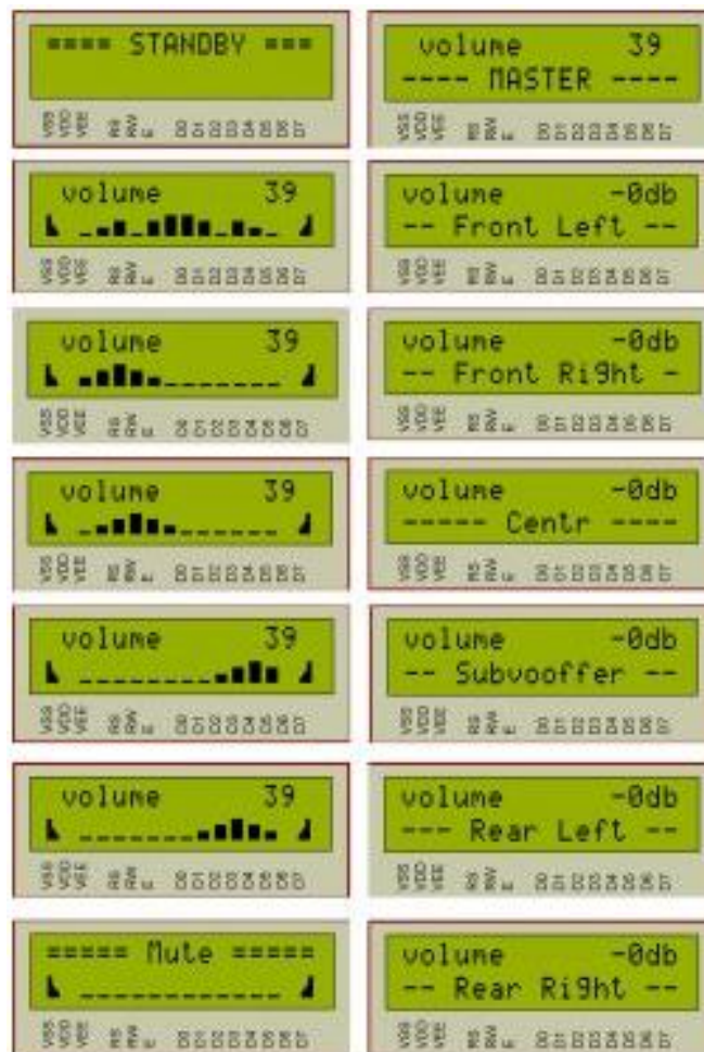
Рисунок 4.2 – Результати комп'ютерного моделювання мікроконтролерного блоку цифрового підсилювача звукових частот
