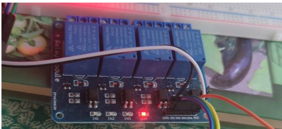
Рисунок 3.17 - Модуль реле при задовільній вологості ґрунту на обох датчиках та низькому рівні освітлення
