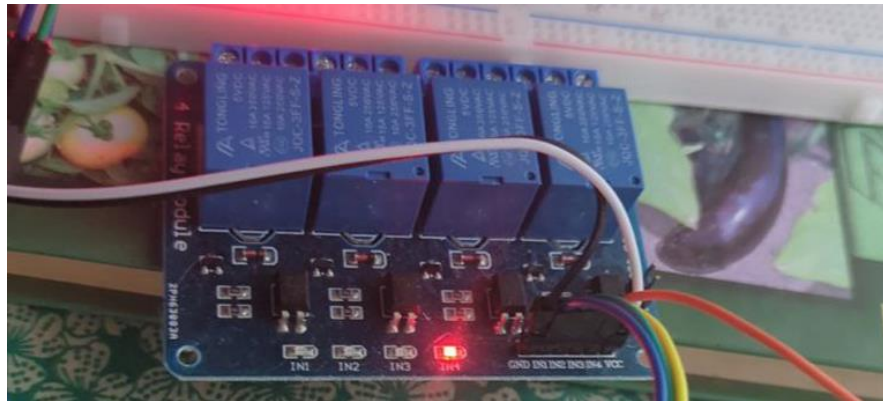
Рисунок 7 – Модуль реле при задовільній вологості ґрунту на обох датчиках та низькому рівні освітлення
