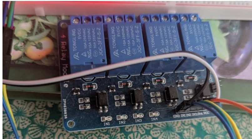
Рисунок 6 – Модуль реле при задовільній вологості ґрунту на обох датчиках та високому рівні освітлення (не горить жоден світлодіод)
