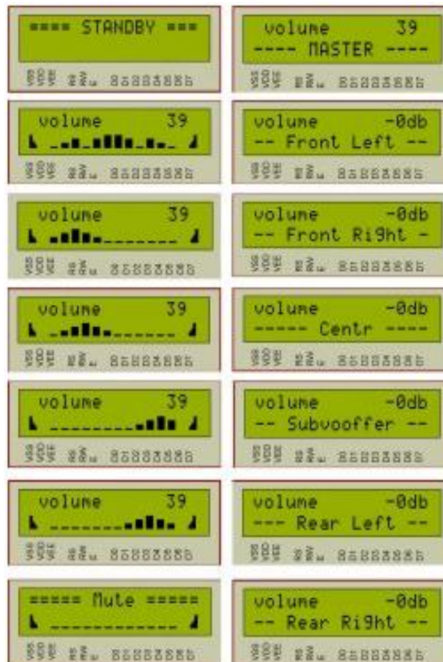
Рисунок 6.2 – Результати комп’ютерного моделювання мікроконтролерного блоку кодера Dolby-Stereo
