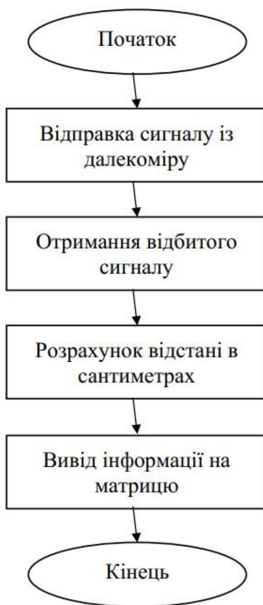
Рисунок 8 – Блок-схема роботи ультразвукового засобу контролю відстані
