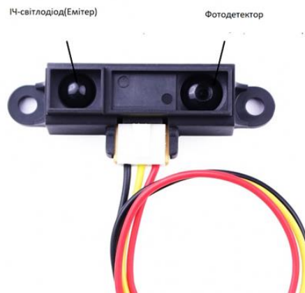
Рисунок 1.8 – Конструкція та загальний вигляд ІЧ-сенсора Sharp
