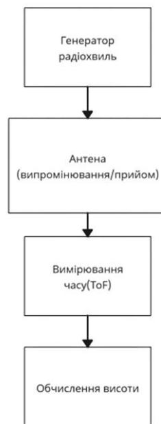
Рисунок 1.3 – Принцип дії радіохвильового(-локаційного) альтиметру
