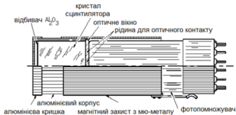
Рисунок 2.4 – Схема сцинтиляційного лічильника.
