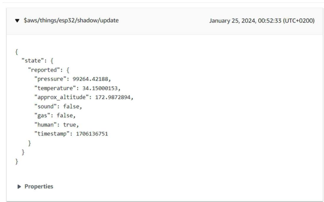
Рисунок 4.2 – Приклад вхідних повідомлень у тестовому MQTT-клієнті середовища AWS IoT Core
