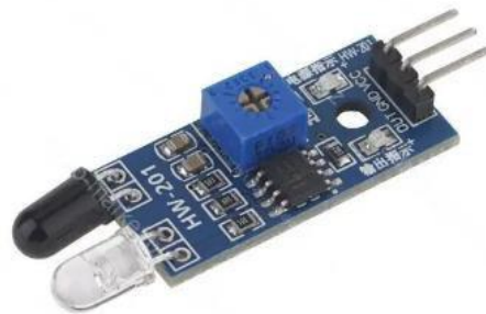
Рисунок 2.2 – IR-сенсор перешкод IR-MD08
