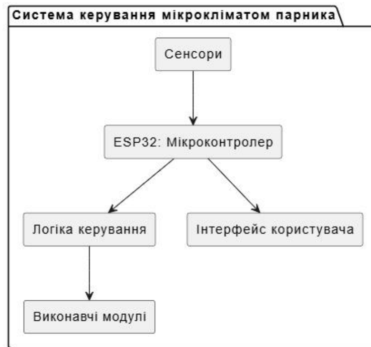
Рисунок 3.4 – Структурна діаграма взаємозв'язків між компонентами системи керування мікрокліматом парника
