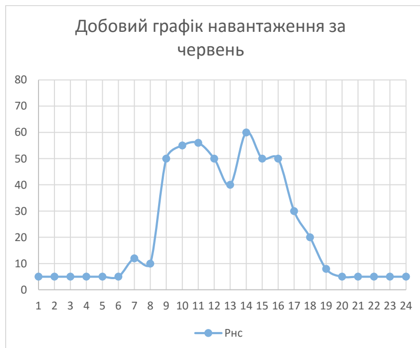
Рисунок Ж.1 – Добові графіки навантажень для характерних днів січня (а) і червня (б) 2011 року
