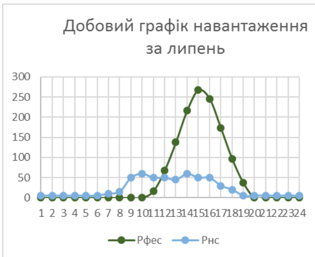
Рисунок И.1 – Графіки споживання потужності підприємством та генерації фотоелектричною станцією : а) за характерну добу січня; б) за характерну добу квітня; в) за характерну добу липня; г) за характерну добу жовтня
