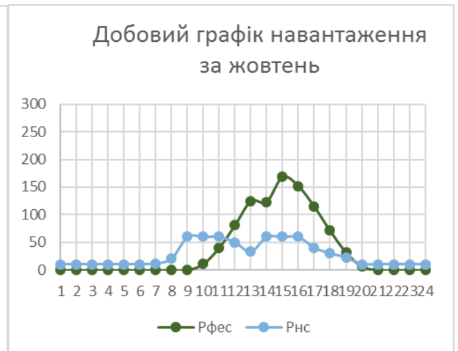
Рисунок И.1 – Графіки споживання потужності підприємством та генерації фотоелектричною станцією : а) за характерну добу січня; б) за характерну добу квітня; в) за характерну добу липня; г) за характерну добу жовтня
