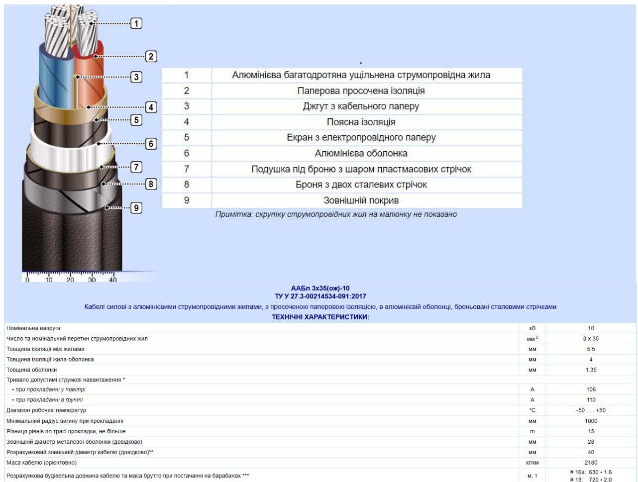
Рисунок 2.2 – Будова та характеристики кабелів
