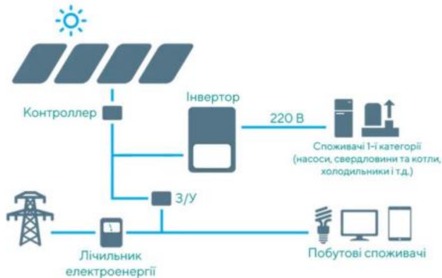
Рисунок 3.5 – Схема підключення мережевої СЕС
