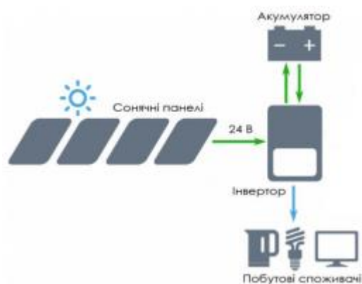
Рисунку 3.7 – Схема підключення автономної СЕС
