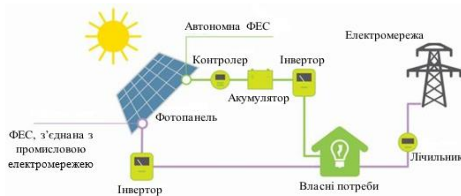
Рисунок 3.8 – Принцип роботи фотоелектричної станції з мережею
