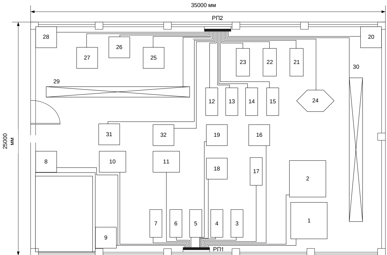
Рисунок 2.2 – План електропостачання плановоремонтного цеху
