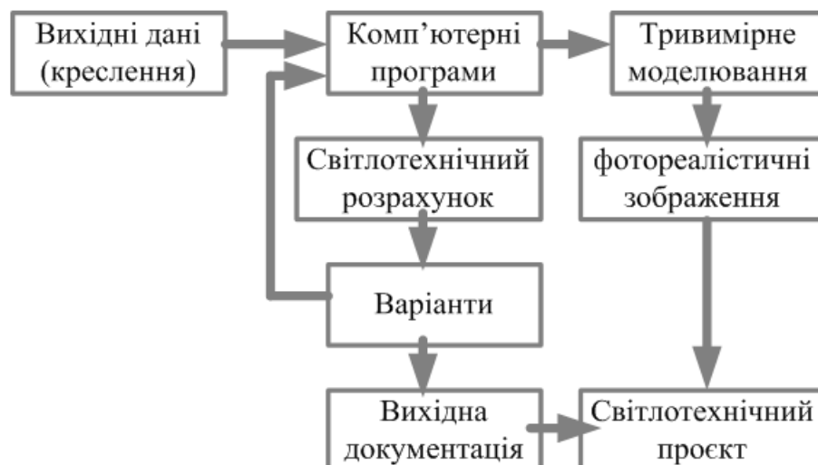
Рисунок 3.3 – Схема виконання етапів світлотехнічного проекту
