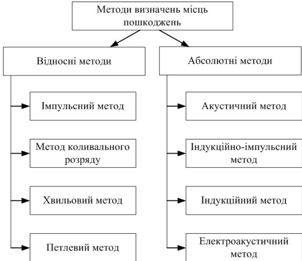
Рисунок 3.1 – Методи визначення місць пошкодження кабелів
