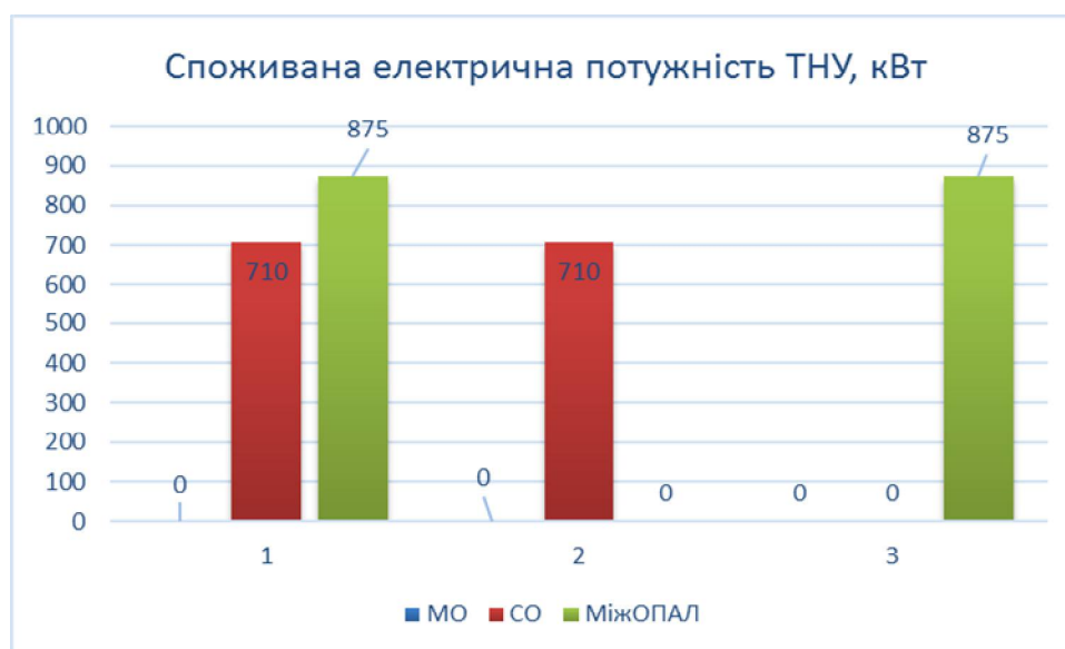
Рисунок 2.18 – Результати моделювання електричної потужності ТНУ
