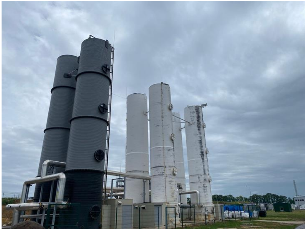
Рисунок 2.3 – Зовнішній вигляд системи очистки біогазу від сірководню.
