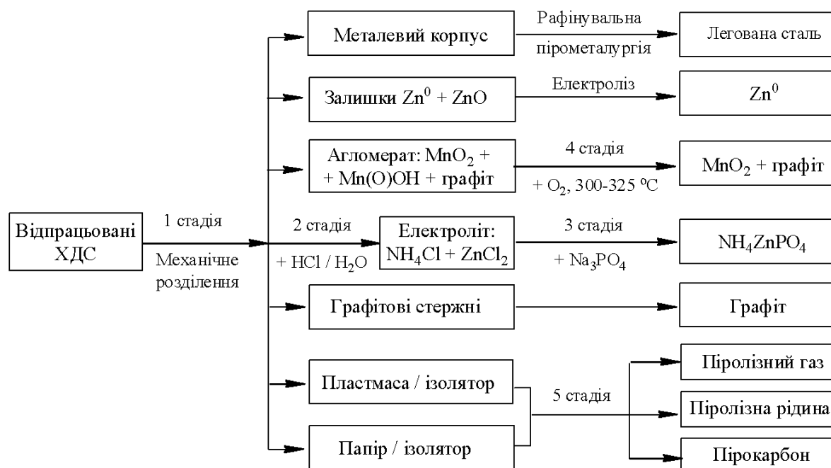
Рисунок 4.4 – Загальна схема комплексної переробки відпрацьованих \text{MnO}_2 – Zn батарей
