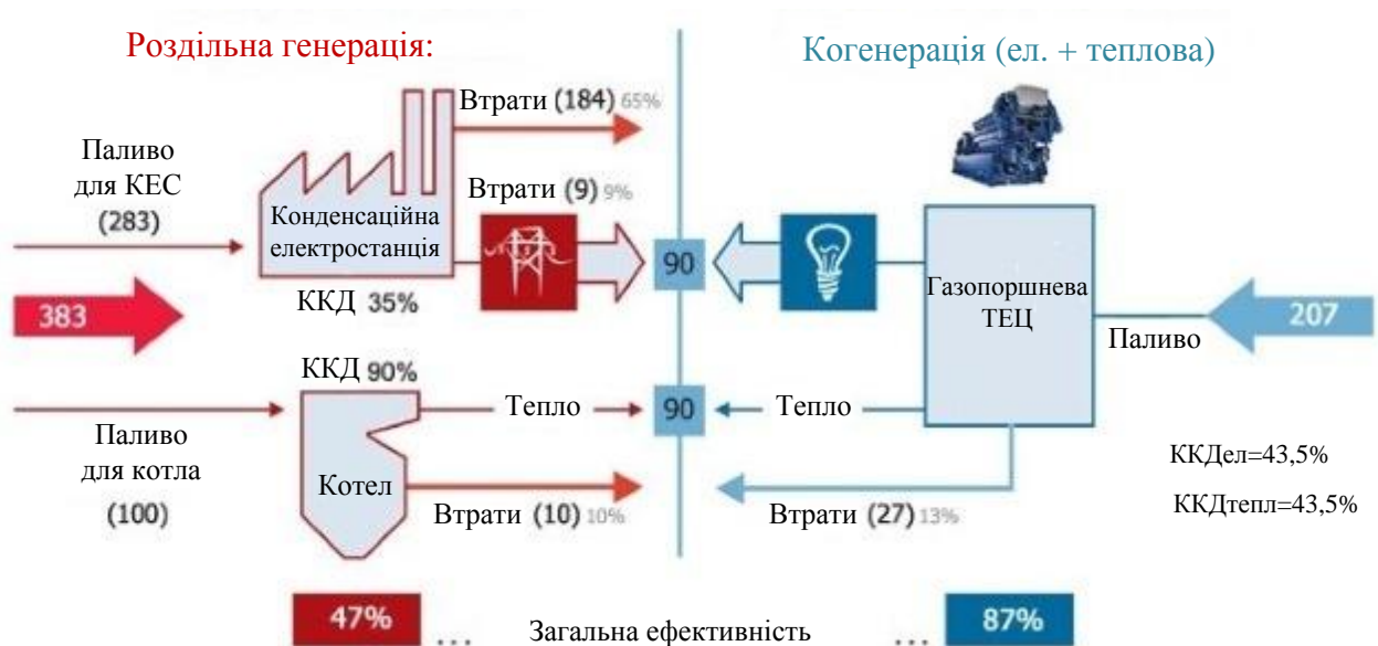
Рисунок 2.1 – Порівняння енергетичних потоків при роздільному і комбінованому виробленні енергії (когенерація), (дані наведені в умовних одиницях палива)
