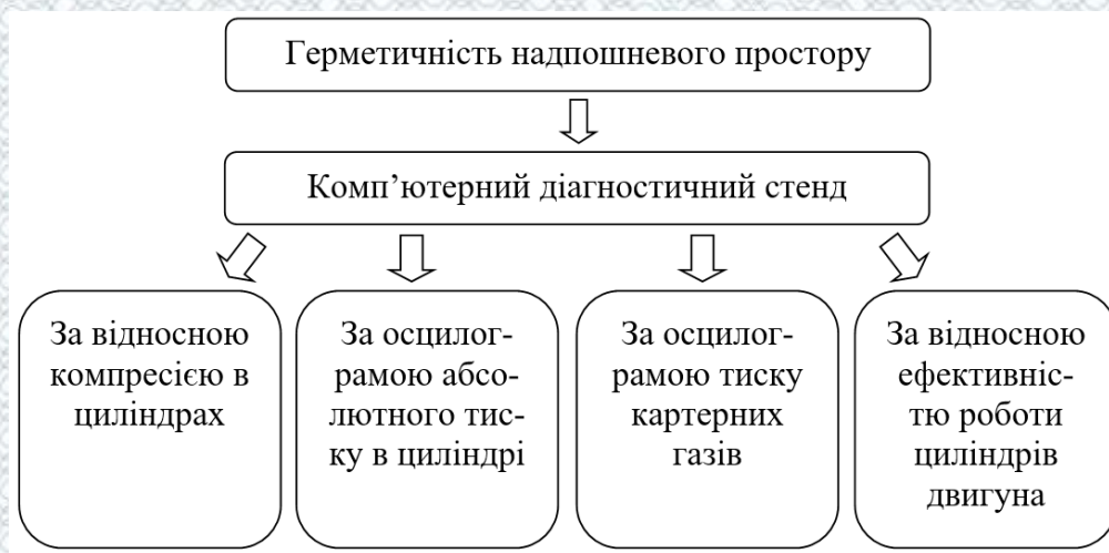
Рисунок 3.3 – Діагностування двигуна за герметичністю надпоршневого простору за допомогою мотор-тестера
