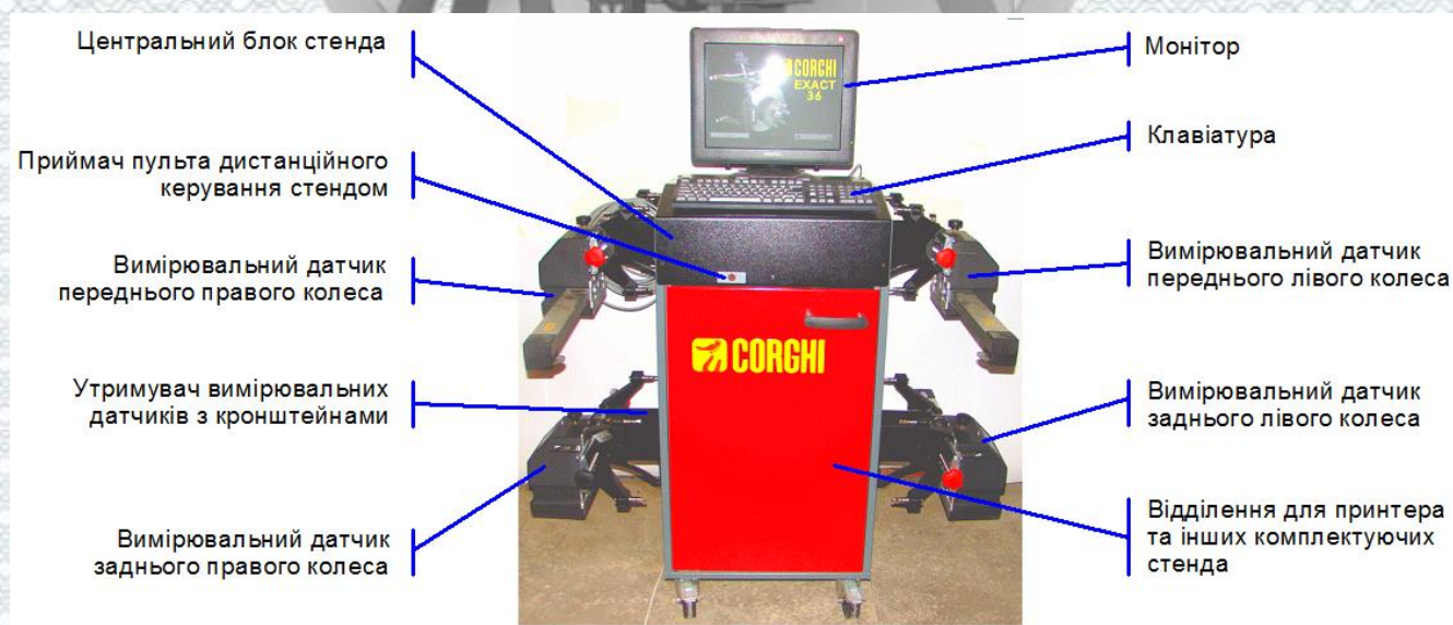
Рисунок 3.1 – Комп'ютерний стенд аналізу геометрії ходової частини
