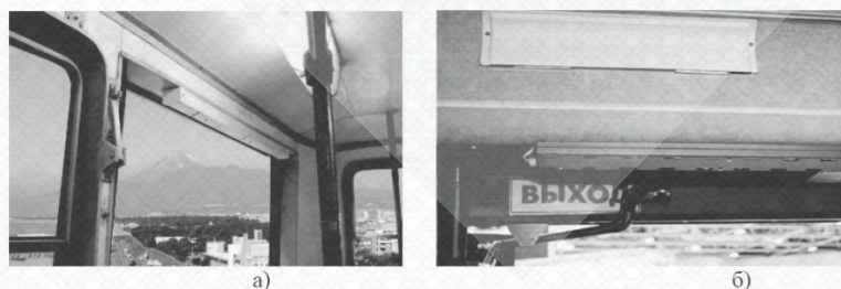
Рисунок 2.15 - Активні багатопроменеві інфрачервоні датчики: а) СПП; б) «Штрих-М»
