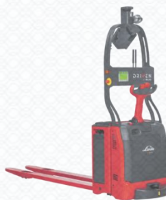
Рисунок 3.10 - Інноваційний роботизований електровізок Т-МАТІС
