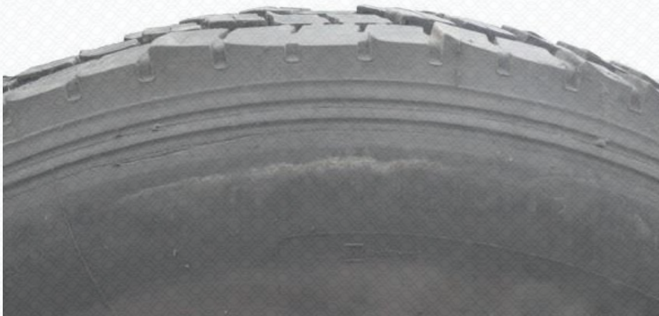
Рисунок 3.8 – Пилкоподібний знос шини, обумовлений дією сходження
