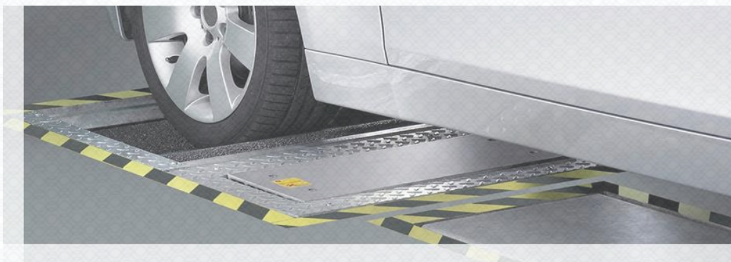
Рисунок 3.16 - Комплексна діагностика ходової частини автомобіля SDL + ATZ
