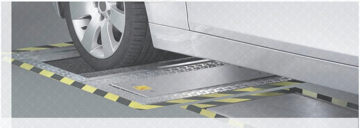
Рисунок 3.11 - Лінія діагностики ходових якостей з автомобілем, що досліджується на СТО
