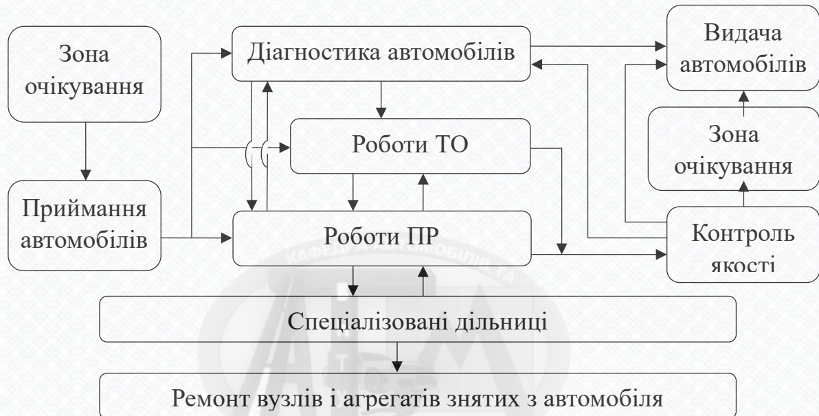
Рисунок 1.4 – Схема технологічного процесу ТО і ПР автомобілів на СТО
