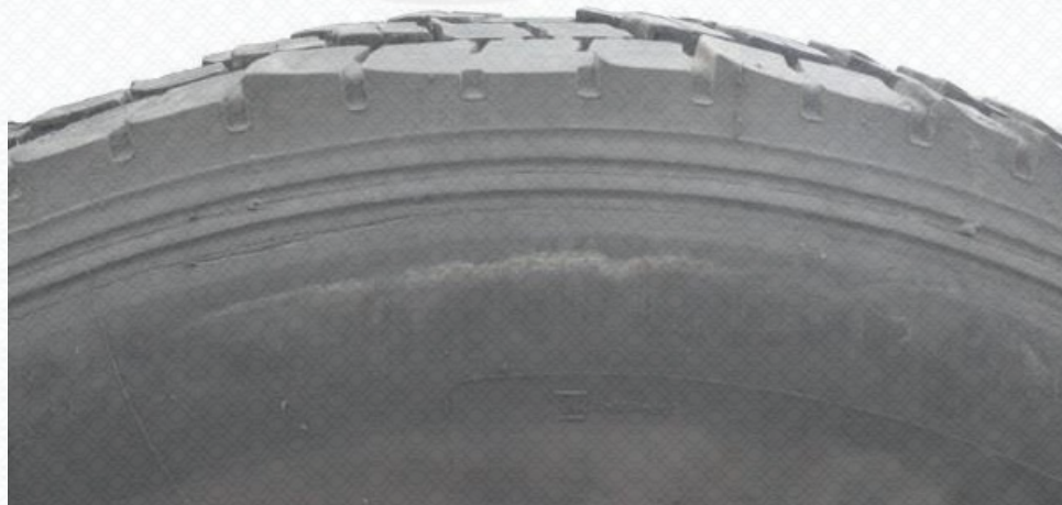
Рисунок 3.4 – Пилкоподібний знос шини
