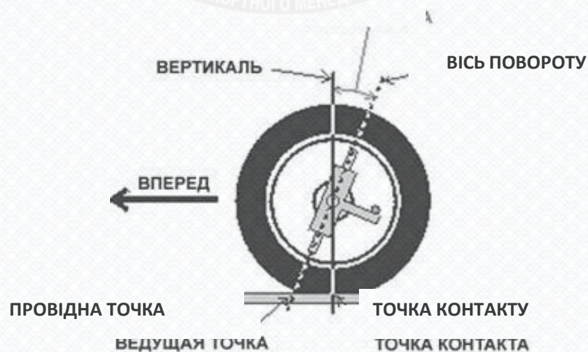
Рисунок 3. 12 – Схема кута кастеру між вертикаллю і проекцією осі повороту колеса на поздовжню площину автомобіля
