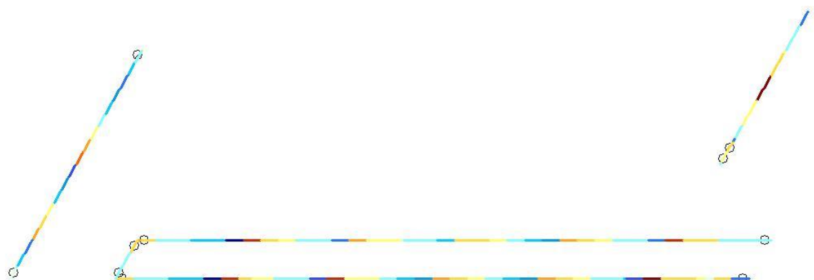
Рисунок 2.16 – Силеві фактори у збірних ригелях підвалу: а – згинальні моменти, M_y , кНм; б – поперечна сила Q_z , кН.
