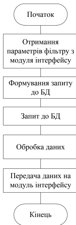
Рисунок 2.8 – Блок-схема алгоритму роботи модуля
