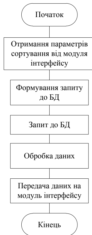
Рисунок 2.7 – Блок-схема алгоритму роботи модуля сортування системи
