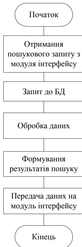
Рисунок 2.6 – Блок-схема алгоритму роботи модуля пошуку системи
