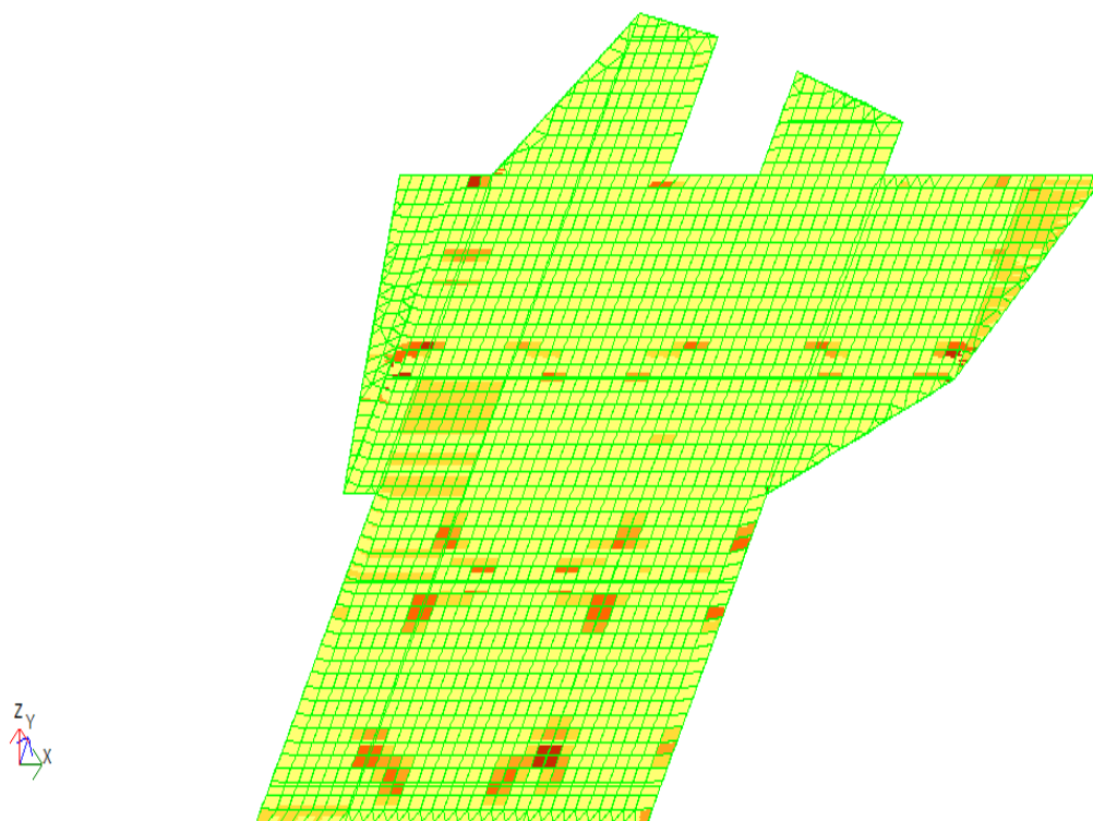
Рисунок 2.9 – Схема армування плити по осі X у верхній грані
