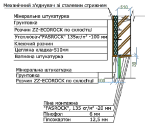
Деталь утеплення віконних укосу і зовнішніх стін
