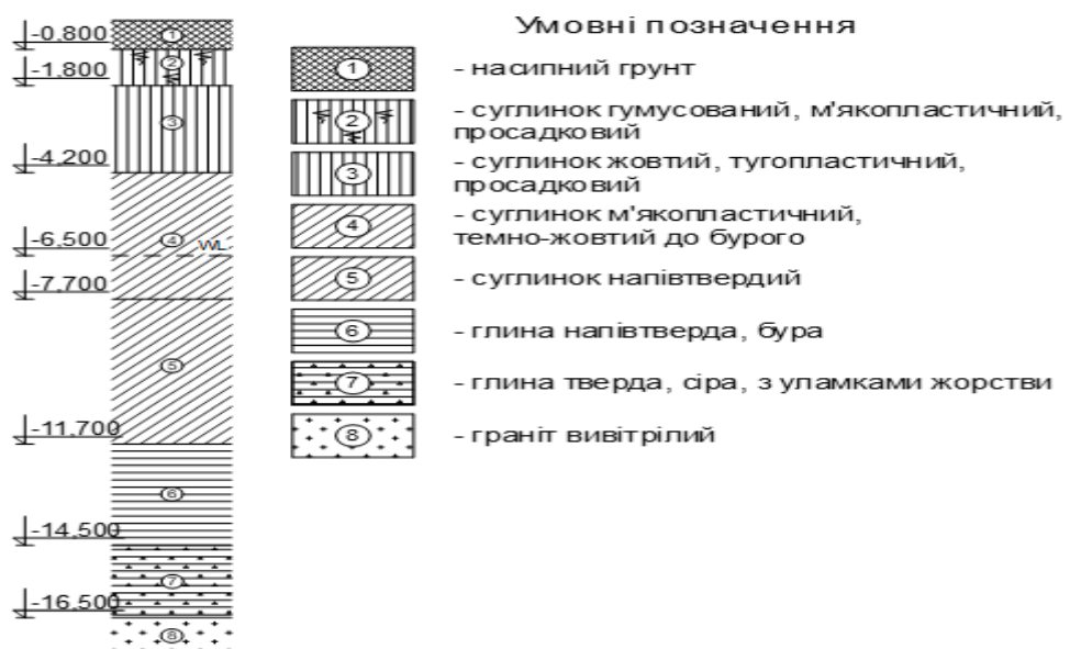
Рисунок 3.1 – Інженерно-геологічний розріз будівельного майданчику
